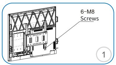
Sechs M8-Schrauben, die der Größe der VESA-Löcher entsprechen, werden verwendet, um die beiden vertikalen Stangenaufhängungen an den VESA-Montagelöchern auf der Rückseite des Touchscreens zu befestigen.
